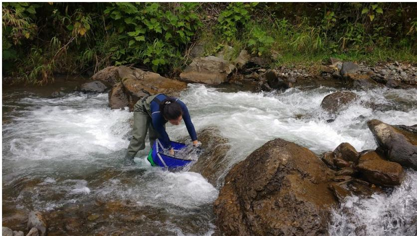
FIGURA 52. COLECTA DE MUESTRAS CON RED SURBER EN RÁPIDOS
