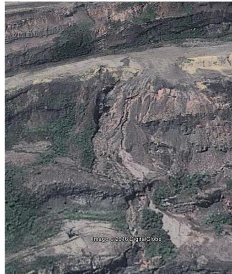
FIGURA 47. FOTOGRAFÍA CON IMÁGENES DE PROCESOS EROSIVOS EN DIFERENTES TAJOS DE CERREJÓN CAPTURADOS DEL GOOGLE.EARTH (FECHA DE CONSULTA 24 DE SEPTIEMBRE). EVIDENCIAS DE LA EROSIÓN COMO MECANISMO NO CONSIDERADO DE INESTABILIDAD DE LOS TALUDES.
