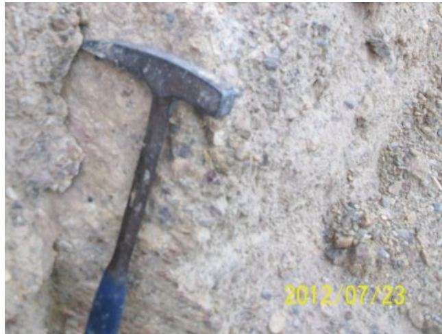
FIGURA 14. PLANO DE FALLA MESOSCÓPICA DE CARÁCTER SINISTRAL SOBRE CONGLOMERADOS DE LA FM. GUALANDAY. LAS ESTRÍAS DE FALLA SE OBSERVAN EN EL PLANO DONDE DESCANSA EL MARTILLO.
