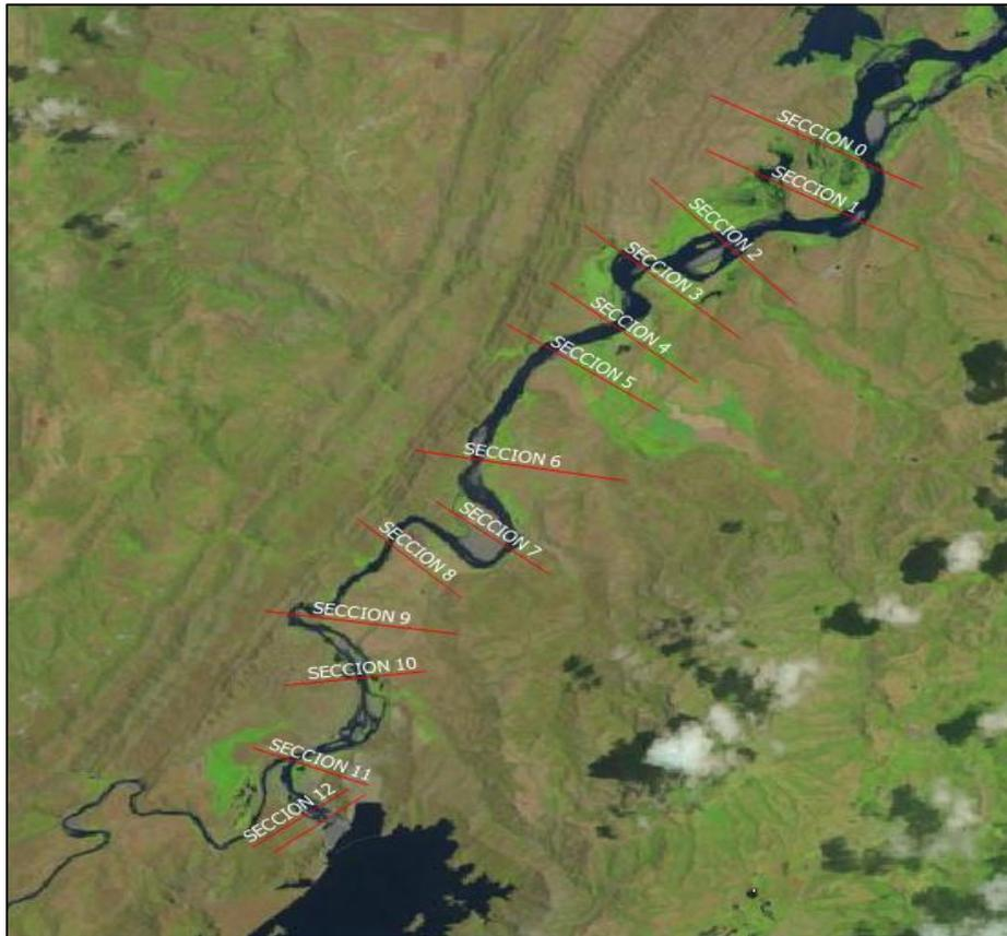
**FIGURA 46.** SECCIONES TRANSVERSALES PROPUESTAS PARA LA MODELACIÓN. FUENTE: ELABORACIÓN PROPIA.
