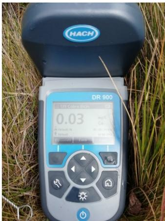
FOTOGRAFÍA 1 COLORÍMETRO MIDIENDO LA CONCENTRACIÓN DE COBRE EN UNA MUESTRA
